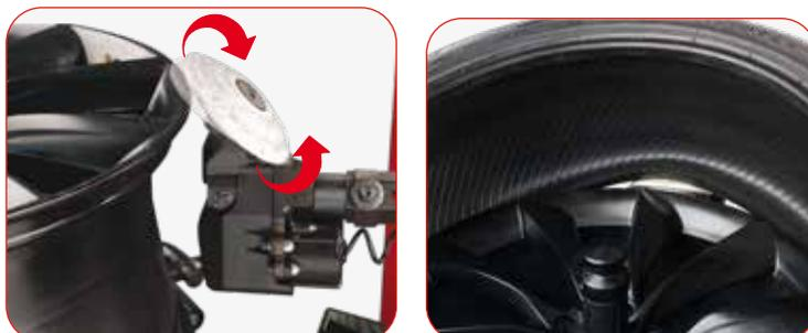
Procedimiento rápido de desmontaje del talón inferior con disco destalonador (indicado especialmente en caso de flancos duros).
