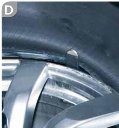
**C-D.** L'outil du bras inférieur aide, si nécessaire, cette opération sur des pneus particulièrement souples.
