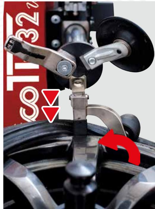
Opération de **MONTAGE** complet facilité par l'outil et le presseur intégré toujours dans la même position.
