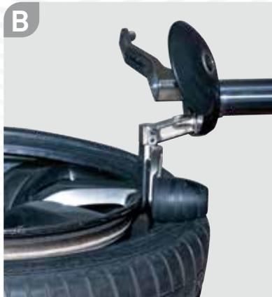
**A-B.** Le DISQUE DÉTALONNEUR supérieur et le rouleau en plastique intégré poussent le pneu dans la jante.
