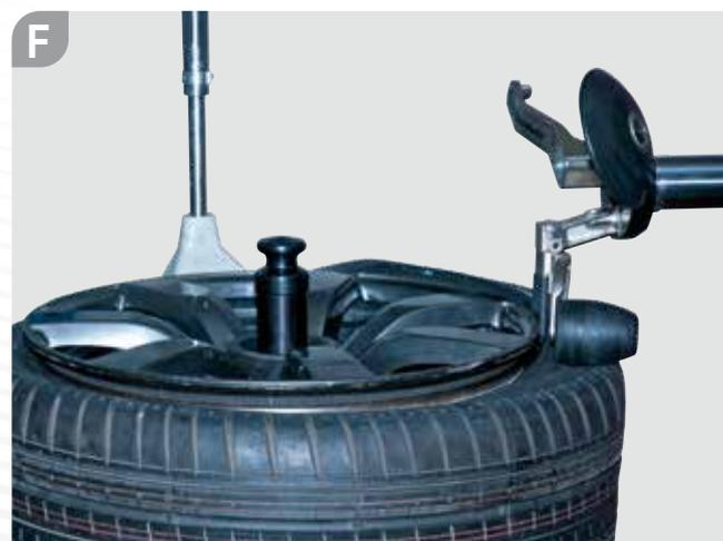
**E-F.** En positionnant l'outil de montage du REVOLVER entre la jante et le pneu, le ROULEAU EN PLASTIQUE du REVOLVER aidera automatiquement le pneu à rester dans le creux.
