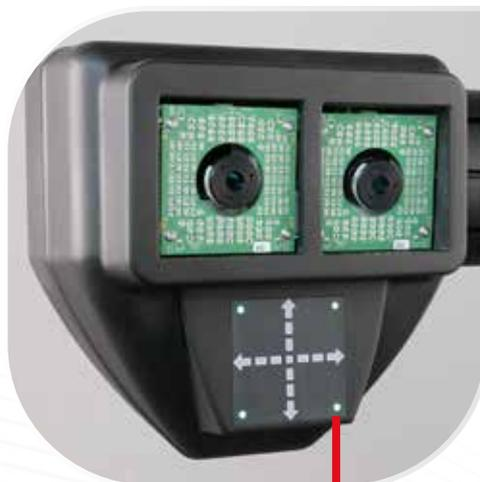
O painel sinótico integrado **com indicações luminosas** permite verificar o estado de engate dos target e guia o operador nas várias fases operacionais. Durante os procedimentos de compensação e de giro, as setas luminosas fornecem informações claras sobre o procedimento em curso.
