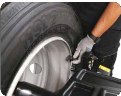
**FR** **DÉTECTEUR INTELLIGENT AUTO-SÉLECTIF 28" ET AWC**: système intelligent d'acquisition automatique de la distance, diamètre 28" avec fonction intégrée auto-sélectif activant automatiquement les programmes d'équilibrage et ne nécessitant pas de sélections depuis le clavier.
