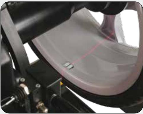
**FR** **APPLICATION DES CONTRE-POIDS AUTOCOLLANTS**: Teco930 fonctionne sur la base des préférences de l'opérateur. Le positionnement des contre-poids autocollants peut être réalisé selon trois modes différents :
