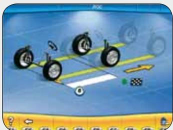
**ES PROGRAMAS COMPENSACIÓN «RUN-OUT»:** disponibles 3 programas de descentrado para compensar problemas sobre llanta y neumático y errores causados por un incorrecto montaje llanta-grapa: ROC de 2 y 3 puntos tramite rotación de la garra de 180° y ROC de empuje que elimina la necesidad de levantar el vehículo
