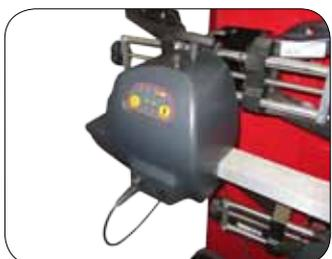
**ES SISTEMA ALIMENTACIÓN:** Sistema alimentación tramite baterías comerciales recargables de tipo AA con dispositivo de recarga integrado sobre el cuerpo maquina. Provisto estándar con cables de emergencia.
