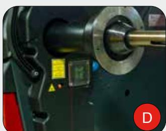
**IT** **LINEA LASER ED ILLUMINATORE CERCHIO:** Standard con linea Laser ed illuminatore cerchio. Il sistema Laser assiste l'operatore durante il posizionamento del peso adesivo ad ore 6 durante l'utilizzo dei programmi ALU. La luce a LED supporta l'utilizzatore durante le fasi di pulizia cerchio ed applicazione pesi.
