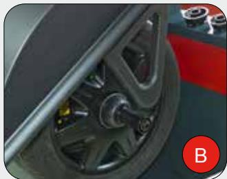
**IT** **INSERIMENTO PARAMETRO LARGHEZZA RUOTA:** Programma di stima automatica della larghezza ruota che si basa su un'analisi statistica dei parametri rilevati dal tastatore interno. Disponibile su richiesta il nuovo rilevatore sonar esterno KIT TS per l'acquisizione automatica del parametro larghezza.
