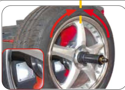
**ES** **POSICIONAMIENTO AUTOMÁTICO:** al finalizar el lanzamiento la rueda se frena e se coloca automáticamente en posición de equilibrado (**RPA**).
