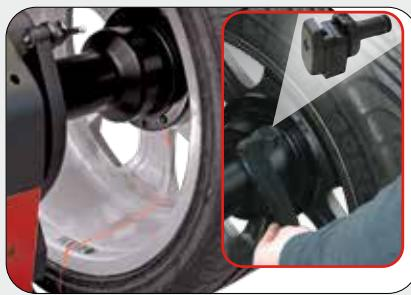
**ES** **LASER LINE:** los contrapesos adhesivos pueden colocarse de manera sumamente rápida utilizando el puntero láser en la posición de las 6 horas o mediante el uso del clip portapesos.
