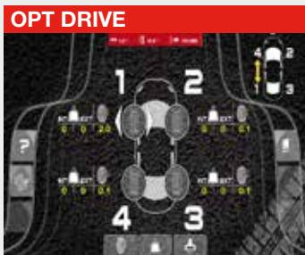
**ES** **OPT Drive** - Herramienta especial de diagnóstico del tren de ruedas del vehículo. Tras memorizar todas las ruedas, Teco 730 Touch propone la mejor manera para posicionarlas en el vehículo, de modo que se favorece el confort y la seguridad del vehículo.
