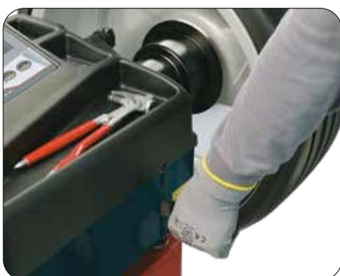
(IT) **FRENO DI STAZIONAMENTO:** facilita le operazioni di bloccaggio e sbloccaggio ruota e l'applicazione dei contrappesi. La leva, nelle versioni motorizzate, permette anche l'azionamento del motore di lancio a 100 giri al minuto.
