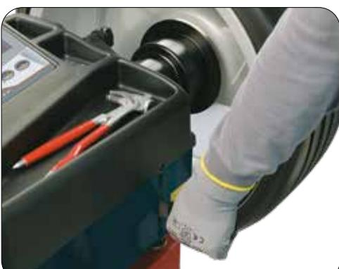
**(FR)** **FREIN DE STATIONNEMENT:** facilite les opérations de blocage et de déblocage de la roue et l'application des contre-poids. Le levier, dans les versions motorisées, permet également le fonctionnement du moteur de lancement à 100 trs/min.
