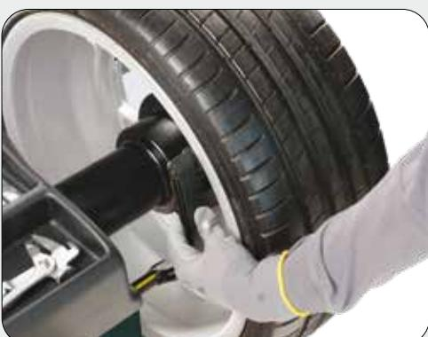
**(FR)** **DÉTECTION DIMENSIONS:** acquisition automatique de la distance et du diamètre de la roue avec sélection automatique des programmes d'équilibrage et programme d'estimation automatique du paramètre largeur roue. Trois systèmes pour le positionnement des contre-poids autocollants : assisté avec clip porte-masse ou manuellement en position 6 heures ou 12 heures.
