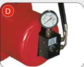
**(ES) DISPOSITIVOS DE SEGURIDAD:** La TECO 58 M está equipada con una serie de dispositivos para garantizar la máxima seguridad de trabajo: válvulas de retención sobre mandril auto-centrante, válvula de seguridad sobre el sistema hidráulico e interruptor magneto-térmico para la protección del motor. Botón de parada en el manipulador para detener la máquina en caso de activación accidental de un comando.
