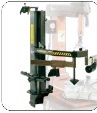
(IT) **DISPOSITIVO PNEUMATICO UNIVERSALE UPH & BPS (OPTIONAL):** Attrezzatura pneumatica ausiliaria UPH che assiste l'operatore durante il montaggio e lo smontaggio di ruote ribassate o particolarmente difficili come le «Run-Flat». Tale dispositivo brevettato evita di dover utilizzare la leva durante lo smontaggio del secondo tallone. Generalmente fornito completo di secondo pressore flottante BPS.
