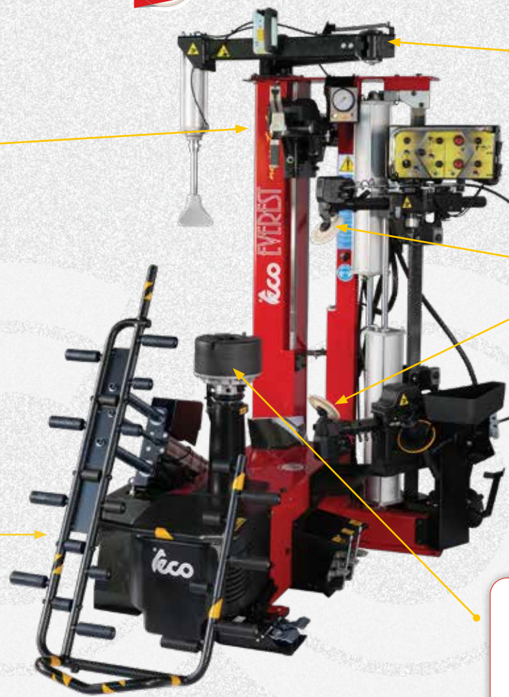
Gruppo stallonatore - Sistema dinamico Bead breaking - Dynamic system
