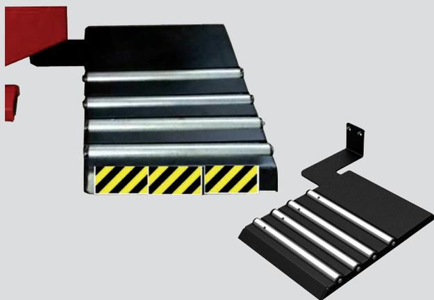
La pedana per supporto ruota mobile è un accessorio molto utile in fase di stallonatura ruota, questo infatti consente un agevole rotolamento della ruota sullo stesso asse per facilitare il posizionamento della paletta stallonatrice, senza effettuare sforzi per doverla sollevare e ruotare.
