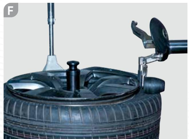
**E-F.** Posizionando l'utensile di montaggio del REVOLVER tra cerchio e pneumatico, automaticamente il RULLO IN PLASTICA del REVOLVER aiuterà lo pneumatico a rimanere nel canale.
