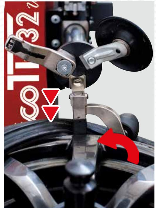
**Operazione di MONTAGGIO completo agevolato da utensile e pressore incorporato sempre alla stessa posizione.**
