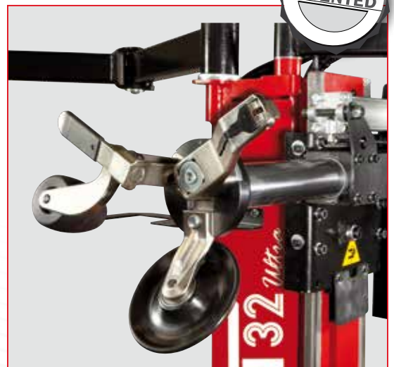
MULTIFUNKTIONS-WERKZEUGREVOLVER 4 WERKZEUGE - 3 POSITIONEN - AUTOMATISCHE DREHUNG
