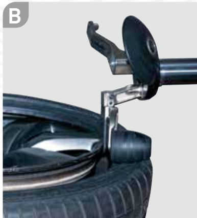
A-B. Die obere ABDRÜCKSCHEIBE und die integrierte Kunststoffrolle drücken den Reifen in die Felge.
