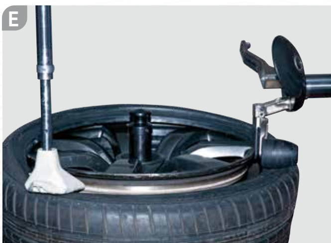
E-F. Durch die Positionierung des Montagewerkzeugs des WERKZEUGREVOLVERS zwischen Felge und Reifen sorgt die KUNSTSTOFFROLLE des WERKZEUGREVOLVERS automatisch dafür, dass der Reifen im Felgenbett bleibt. Die Drehung der Mittelezentrierung und der Einsatz des serienmäßigen drehbaren Wulstniederhalters, machen die Endmontage besonders einfach.
