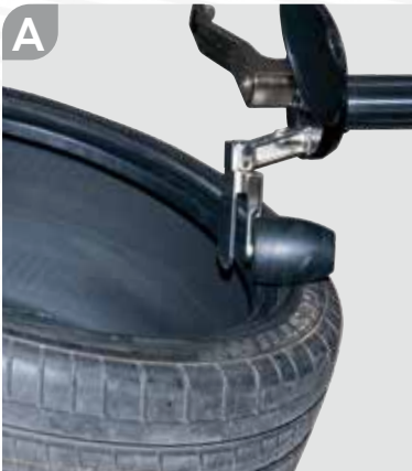
A-B. Die obere ABDRÜCKSCHEIBE und die integrierte Kunststoffrolle drücken den Reifen in die Felge.
