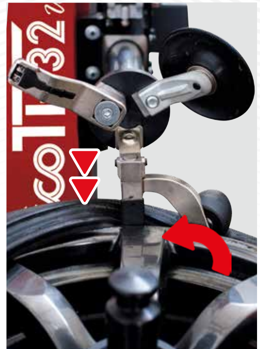
Die vollständige MONTAGE wird durch das Werkzeug und den eingebauten Andrücker, der sich immer in derselben Position befindet, erleichtert.
