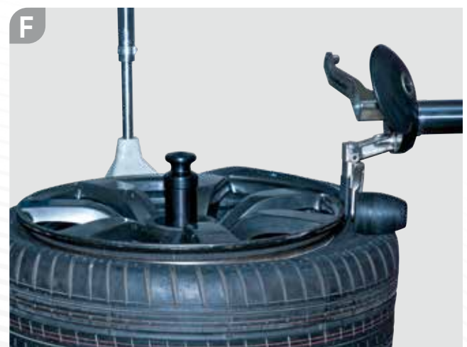
E-F. Durch die Positionierung des Montagewerkzeugs des WERKZEUGREVOLVERS zwischen Felge und Reifen sorgt die KUNSTSTOFFROLLE des WERKZEUGREVOLVERS automatisch dafür, dass der Reifen im Felgenbett bleibt. Die Drehung der Mittelezentrierung und der Einsatz des serienmäßigen drehbaren Wulstniederhalters, machen die Endmontage besonders einfach.
