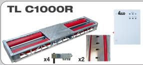
Banda de rodiamento: 800-2.800 mm Diámetro del rodillo: 205 mm Velocidad de ensayo: 2,6 Kmh Potencia de frenado: 32 kN Motores: 2 x 7,5 kW Capacidad de prueba de carga: 12 t Voltaje: 3Ph/400V/50Hz
