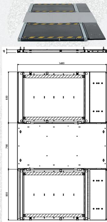
Installation au-dessus du sol avec rampes de montée et de descente
